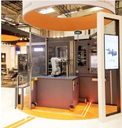
DESMA透過非接觸式安全系統應對機器人應用，此系統能排除操作人員的事故發生危險，同時確保員工無障礙進入機器
