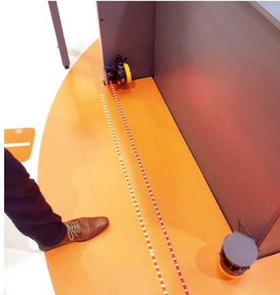
若有人員接近機器人，水平防護型安全區域雷射掃描器會及早識別，然後放緩引發危險的機器人運動，從而規避危險
