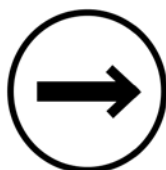
Illustration 4 : Marquage des contacts à manœuvre positive d'ouverture selon EN 60947-5-1, annexe K
