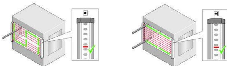
**Geräte mit deaktivierter Wiederanlaufsperrde:** Wenn die Feldanzeige bzw. der integrierte Leuchtmelder am Empfänger auch nur kurzzeitig grün aufleuchten, dann darf an der Maschine nicht mehr gearbeitet werden.
