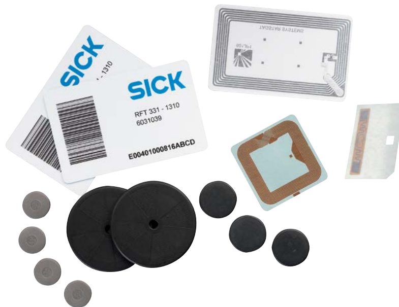
Abbildung 2: Passive HF und UHF RFID Transponder in verschiedenen Formen erleichtern die Anbringung an Objekte und die Verwendung als Identifikationskarte. Die Antennen- und Chipdesigns von UHF und HF Tags unterscheiden sich aufgrund der unterschiedlichen Funktionsweise der Energie und Datenübermittlung deutlich (Tag ganz rechts: UHF, Rest: HF).
