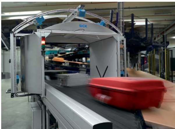
Abbildung 1: Kombinationen der Technologien RFID und Laserscanner kommen beispielsweise an Flughäfen in Gepäckidentifikationssystemen für die Gepäcksortierung (links) und in Self-Bag Drops (rechts) zum Einsatz.
