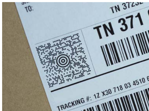
Abbildung 6: Paketdienste setzen oft eine Kombination aus 1D und 2D Codes (hier ein Maxi Code) ein.
