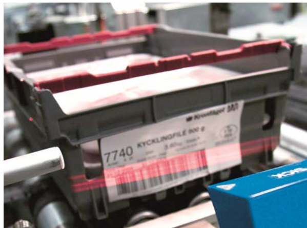
Abbildung 4: Schwingspiegelscanner lesen Barcodes innerhalb eines vorgegebenen Bereichs auch unter schwierigen Lichtverhältnissen.
