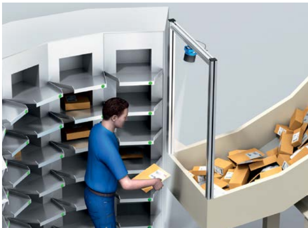
Abbildung 8: Matrixkameras lesen gedruckte oder direkt markierte 1D und 2D Codes, beispielsweise während des Sortiervorgangs von Päckchen (links) oder zur eindeutigen Identifikation von Bauteilen wie Motorblöcken in der Fertigung (rechts).
