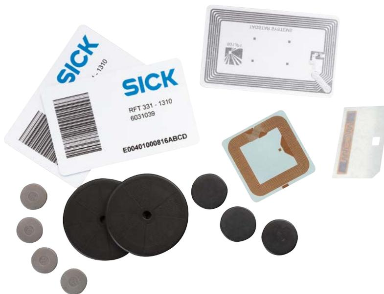
Figura 2: Transponders passivos HF e UHF RFID em diferentes formas facilitam a sua colocação em objetos e o uso do cartão de identificação. Os designs das antenas e de chips de transponders UHF e HF se diferenciam pelo modo de funcionamento da transmissão de energia e de dados (transponders bem à direita: UHF, restante: HF).
