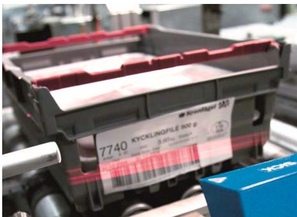
Figura 4: Scanners de espelho oscilante leem códigos de barras dentro de uma faixa prevista também sob condições de luz difíceis.
