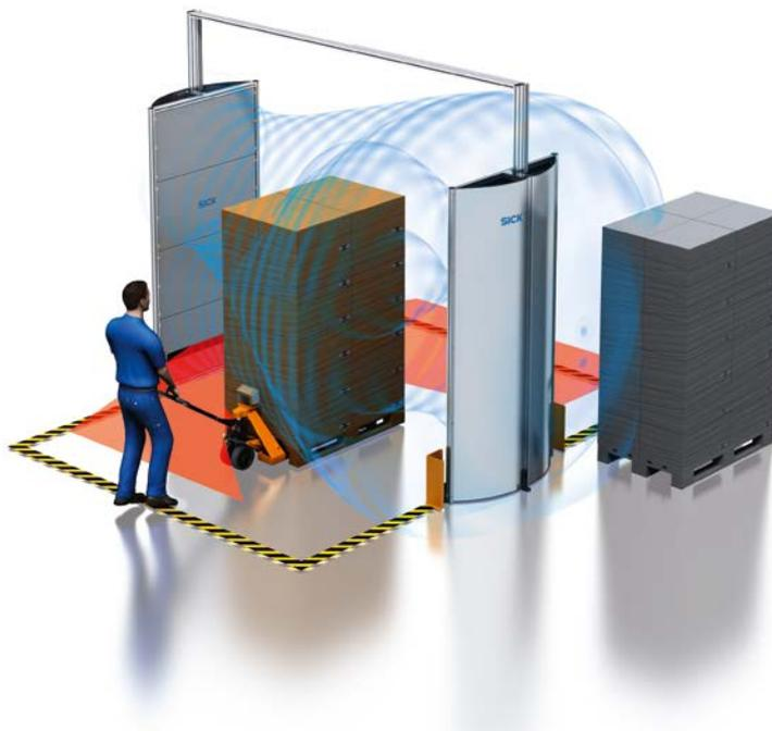
Figura 3: O portão RFID da SICK (RFGS Pro) identifica objetos marcados com RFID que se encontram sobre um pallet ao atravessar o portão. Os transponders fora da faixa de medição são filtrados de modo confiável.
