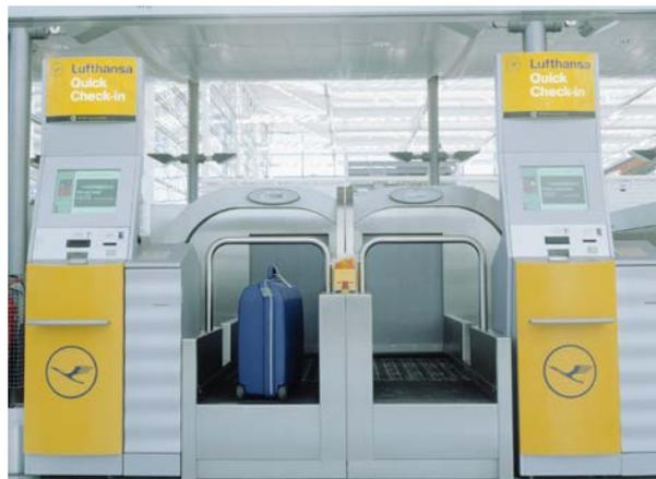
Figura 1: Combinação das tecnologias RFID e scanner a laser são utilizadas, por exemplo, em aeroportos, em sistemas de identificação de bagagem para a classificação da bagagem (à esq.) e em Self-Bag Drops (à dir.).
