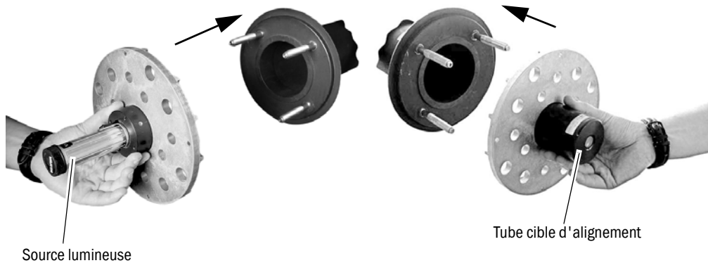
Fig. 5 : Alignement des brides à l'aide du dispositif de réglage optique
