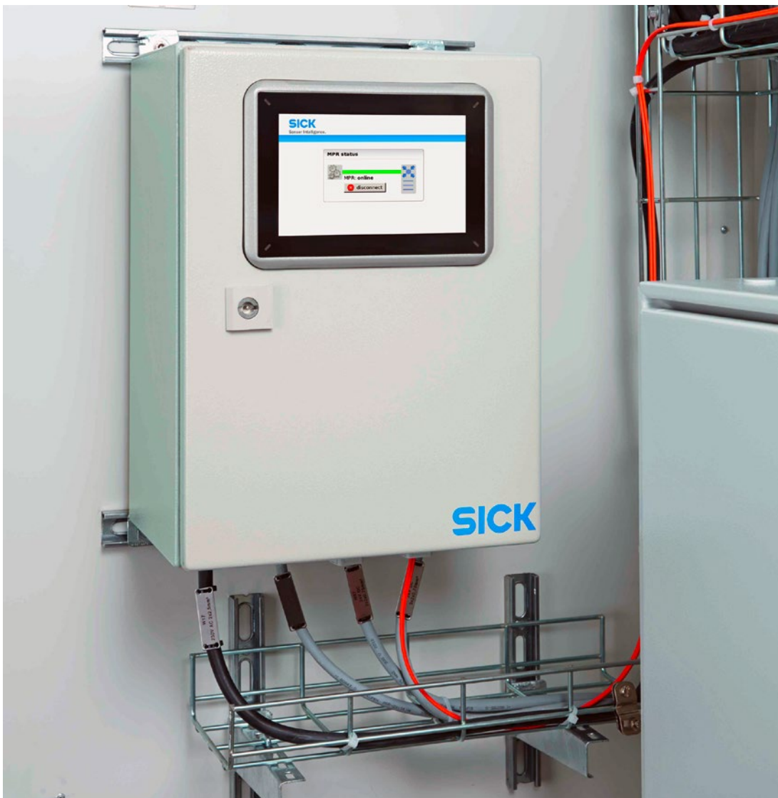
Bild 2: Meeting Point Router: Sicherheit durch Trennung von Maschinennetz und Kundenetz
