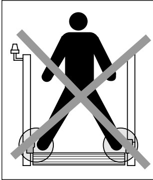
Abb. 1: Gegenüberliegende Sensoren dürfen nicht gleichzeitig aktivierbar sein
