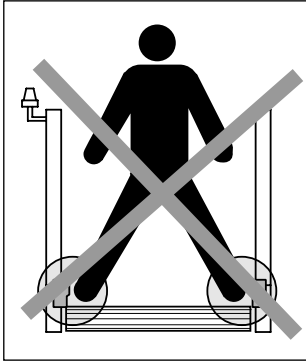
Kuva 1: Toisiaan vastapäätä sijoitetut tunnistimet eivät saa aktivoitua samanaikaisesti.
