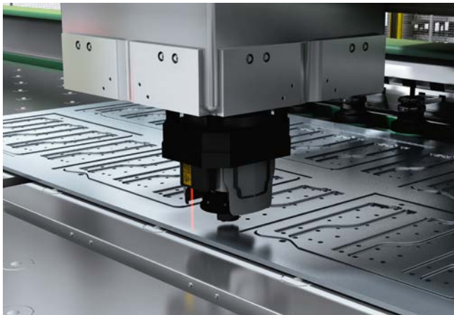
Figura 11: Controle de distância no cabeçote de corte com sensor de deslocamento OD Max
