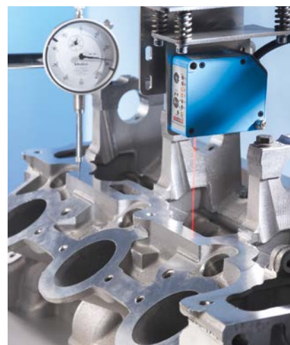
Figura 8: Métodos de medição: Comparação entre método mecânico e método óptico
