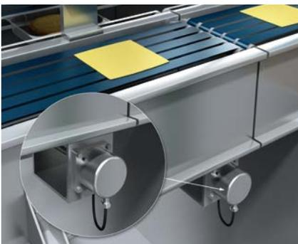
Para controlar el procesado de la carne es necesario sincronizar la velocidad con las siguientes máquinas a la salida de la cortadora. Los encoders incrementales miden esta velocidad.
