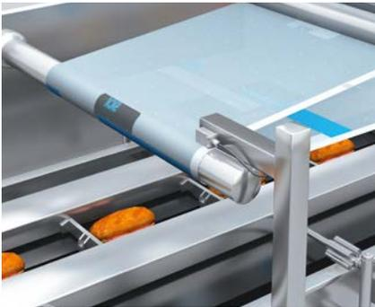
Las marcas de referencia ayudan a detectar de forma segura materiales de envasado en procesos de fabricación automatizados y a colocarlos en la posición correcta. El sensor de contraste KTM detecta estas marcas de manera fiable para garantizar las funciones de la máquina, p. ej., el corte de lámina.
