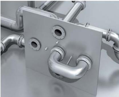
En los depósitos de almacenamiento de la industria de bebidas se utilizan paneles de acoplamiento para controlar el flujo de producción. Mediante estos paneles se conectan las tuberías entre sí. La posición de los puentes de acoplamiento se detecta con el sensor de proximidad inductivo IMF.
