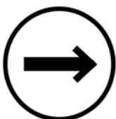
Abbildung 4: Kennzeichnung von zwangsöffnenden Kontakten gemäß EN 60947-5-1 Anhang K
