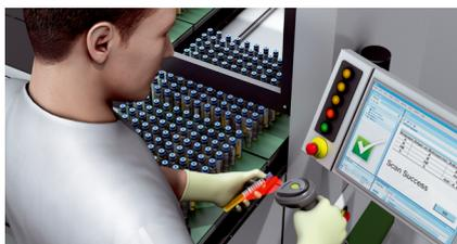
Pour la lecture de codes barres d'échantillons dans l'analyse clinique : un seul appareil permet d'identifier de manière rapide, correcte et sans saisie manuelle de données les types de codes les plus variés.
