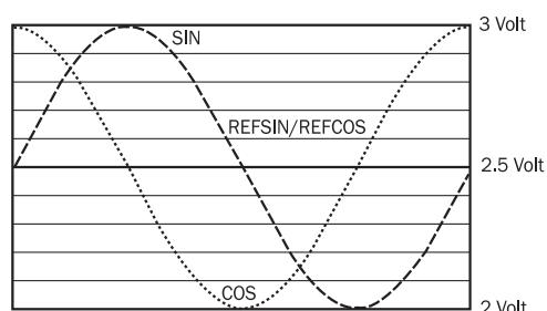
Milin saat yönünde "A" yönüne bakacak şekilde döndürülmeli durumunda sinyal akışı (boyutsal çizime bakınız) 1 döngü = 360 ° : 1024
