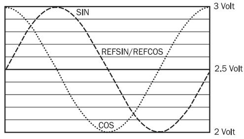
Milin saat yönünde "A" yönüne bakacak şekilde döndürülmesi durumunda sinyal akışı (boyutsal çizime bakınız) 1 döngü = 360 ° : 1024
