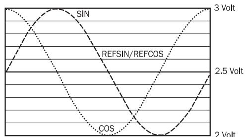
Milin saat yönünde "A" yönüne bakacak şekilde döndürülmesi durumunda sinyal akışı (boyutsal çizime bakınız) 1 döngü = 360 ° : 1024
