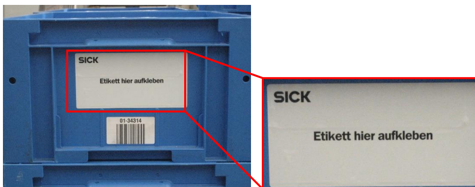
Abbildung 3: (links) Behälter mit sogenanntem Landeplatzetikett. (rechts) Landeplatzetikett; an dieser Stelle sind Labels/Behälterkennzeichnungen am Behälter anzubringen
